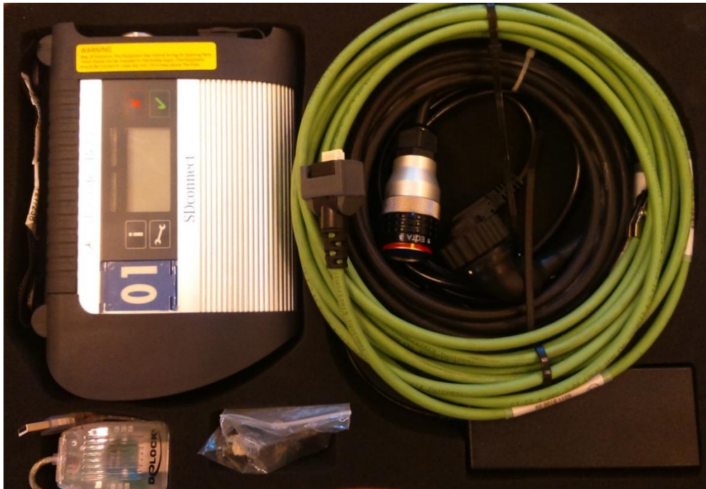
Interface diagnostyczny do komunikacji z procesorem i pamięcią silnika MTU/Mercedes serii BR6 106 TD21 pojazdu JELCZ 442.32
