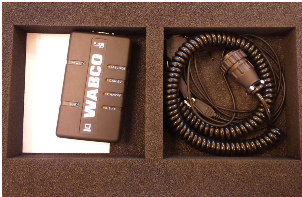
Interface diagnostyczny do komunikacji z centralnym systemem pneumatycznym ABS/ASR pojazdu JELCZ 442.32
