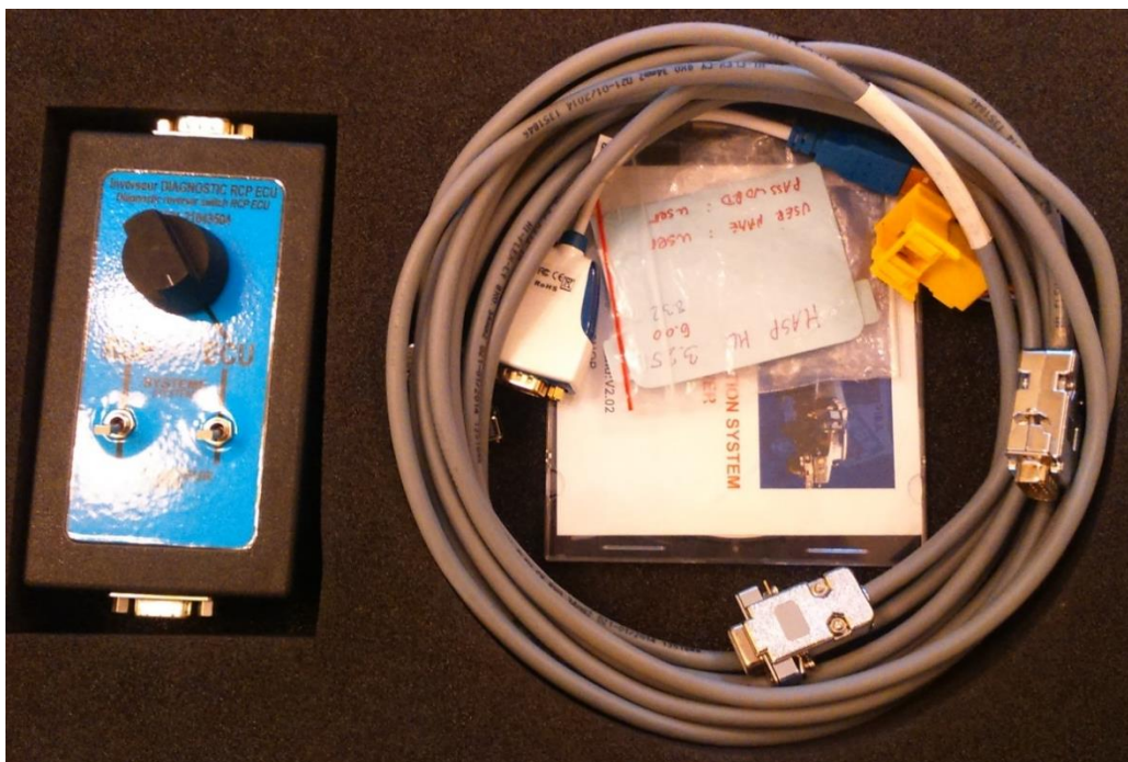
Interface diagnostyczny do komunikacji z centralnym systemem pompowania kół pojazdu JELCZ 442.32
